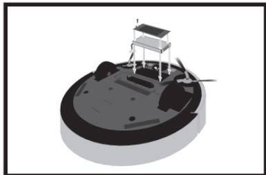
1. Para sua comodidade a bateria do seu **robo** Easy já vem instalada. Realize a primeira carga por 8h contínuas, ligando a fonte de alimentação diretamente no interruptor lateral do robô. Para orientações de como garantir o máximo desempenho da bateria, leia atentamente o capítulo “Limpeza Periódica - Bateria” do seu manual do proprietário.
