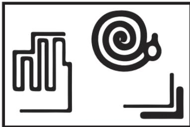
11. O **robo** possui três modos de limpeza pré-programados que alternam entre si automaticamente durante o ciclo de limpeza. Os modos de limpeza Automático, Pontual e Contorno alternam entre si de maneira automática a cada poucos minutos, potencializando a área de cobertura do robo. A utilização diária irá garantir o melhor desempenho da limpeza.
