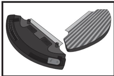
13. Seu **robo** Easy é compatível com um reservatório de água destacável. O reservatório de água, permite a opção de limpeza com MOP úmido.
