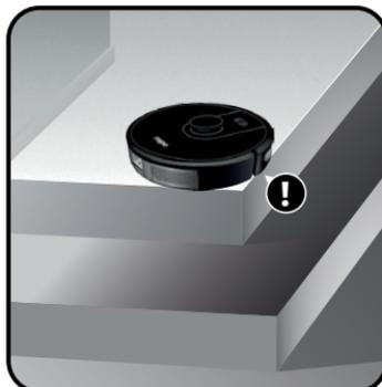
**14** Seu **robo** possui sensores ópticos antiqueda, localizados sob o chassi que evitam que o robô caia de degraus. Também possui sensores mecânicos de impacto, localizados no para-choque que cumprem a função de auxiliar na identificação de obstáculos na rota do robo e redirecionar seu robô.
