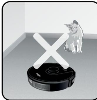
**17** - A utilização inadequada do **robo**, como iniciar ciclos de limpeza com objetos ou animais sobre o mesmo, ou até mesmo a colocação destes durante o funcionamento do aparelho, possivelmente acarretará na danificação dos seus motores elétricos e eixos ou ainda outras partes do robô de forma permanente. Atente-se, pois tal comportamento consequentemente invalidará a garantia do produto.
