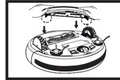
13• Seu **ropo** Pet é compatível com a tecnologia WetClean. O reservatório de água destacável, permite a opção de limpeza com MOP úmido ou seco, ou mesmo a opção de realizar a limpeza sem utilizar o MOP.
