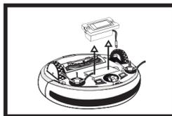
1• Para sua comodidade a bateria do seu **ropo** Pet já vem instalada. Realize a primeira carga por 8h contínuas posicionando o **ropo** corretamente sobre os contatos da base de recarga. Para orientações de como garantir sua vida útil leia atentamente o capítulo "Limpeza Periódica - Bateria" do seu manual do usuário.
