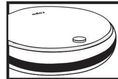
8• Seu **ropo** possui sensores ópticos anti-impacto que evitam contato direto do robô com móveis, rodapés e etc. Objetos escuros ou de espessura reduzida como a quina dos móveis não são detectados pelos sensores ópticos. Sensores de impacto mecânicos funcionarão nestes casos.
