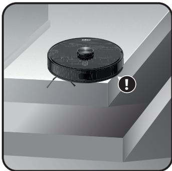
**5** O ropo Smart Laser possui sensores ópticos antiqueda sob o chassi para evitar quedas e sensores ópticos e mecânicos de impacto no para-choque para identificar obstáculos. Além disso, ele possui um sensor ultrassônico para detectar tapetes, fazendo que o robô mude de trajeto quando estiver passando pano ou aumentar aspiração quando estiver aspirando.
