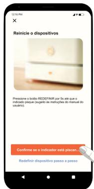
**08.** Na tela seguinte, antes de iniciar a sincronização no aplicativo, é necessário colocar o **robo** em modo de sincronização, como descrito no início deste sub-capítulo. Após colocar o **robo** em stand by, selecione "Confirme se o indicador está piscando".
