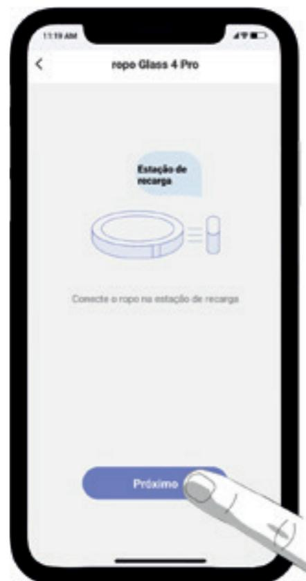
**01.** Caso a sincronização tenha sido bem-sucedida, o app o redirecionará para a tela de inicialização. Posicione o **robo Glass 4 Pro** na estação de recarga autolimpante, garantindo que os contatos metálicos do robô se encostem nos da estação. Em seguida pressione em "Próximo".
