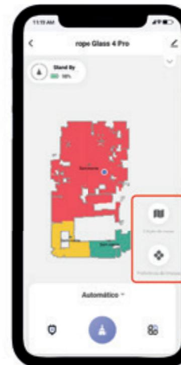
**04.** No menu à direita, é possível mudar parâmetros da limpeza, como potência de aspiração e fluxo de líquido, e fazer edições no mapa como configuração de cômodos e definição de áreas restritas.
