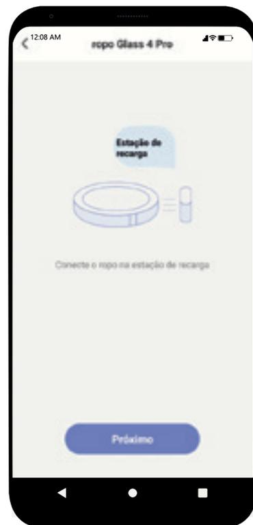
**01.** Caso a sincronização tenha sido bem-sucedida, o app o redirecionará para a tela de inicialização. Posicione o rope Glass 4 Pro na estação de recarga autolimpante, garantindo que os contatos metálicos do robô se encostem nos da estação. Em seguida pressione em "Próximo".
