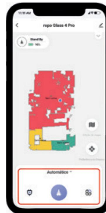
**03.** Esta é a tela inicial do seu robo Glass 4 Pro. No painel inferior, você consegue escolher o modo de limpeza desejado, determinar o retorno do robo à estação de recarga autolimpante, agendar ciclos de limpeza automáticos e muito mais.
