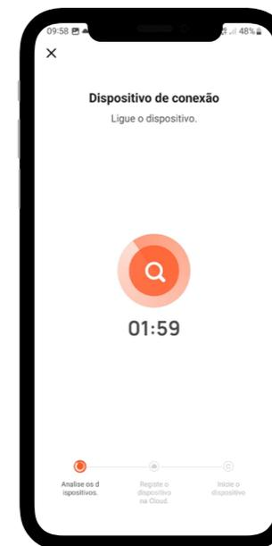
**05.** Após a seleção, uma contagem regressiva surgirá no centro da tela, bem como três indicadores das etapas da sincronização na parte inferior. Não minimize o app e não bloqueie a tela durante esta etapa para evitar erros na sincronização.
