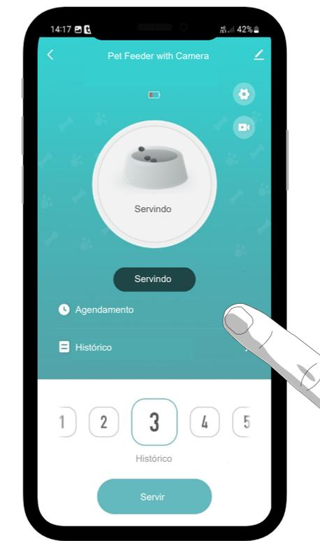
**04.** Após pressionar o botão “Servir”, o PapaPet começará a despejar a quantidade selecionada de porções e o estado do PapaPet será alterado para “Servindo”.
