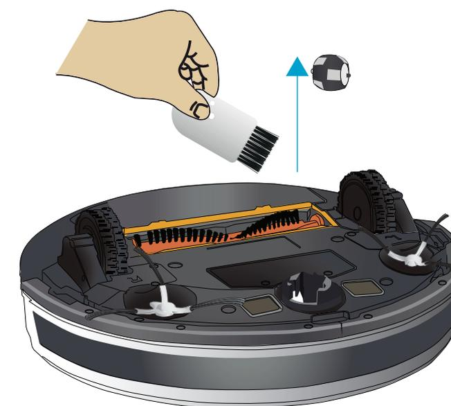
**02.** Puxe a roda para cima para retirá-la do suporte. Com o auxílio da escova de limpeza, retire a sujeira acumulada na roda frontal e no seu suporte.
