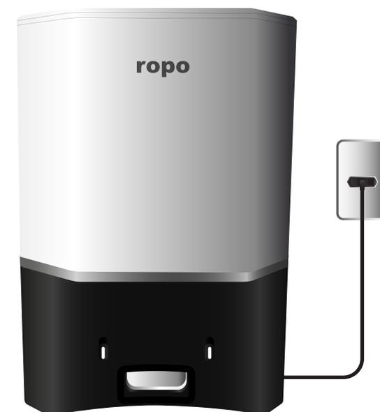
**01.** Instale a estação de recarga autolimpante contra uma parede, em superfície plana e dura. Não instale a estação de recarga autolimpante em superfícies macias, tapetes ou próxima a vãos de porta ou passagens. O sinal emitido pela estação pode impedir que o **robo** atravesse esses vãos.
