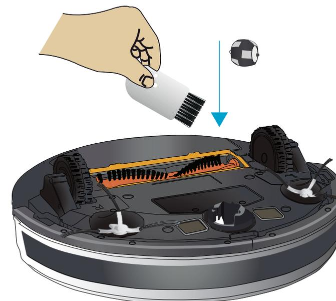
**03.** Após a limpeza, encaixa a roda frontal, alinhando o eixo da roda com os encaixes no suporte e pressione a roda até ouvir um som de "click", indicando que a roda foi bem encaixada.
