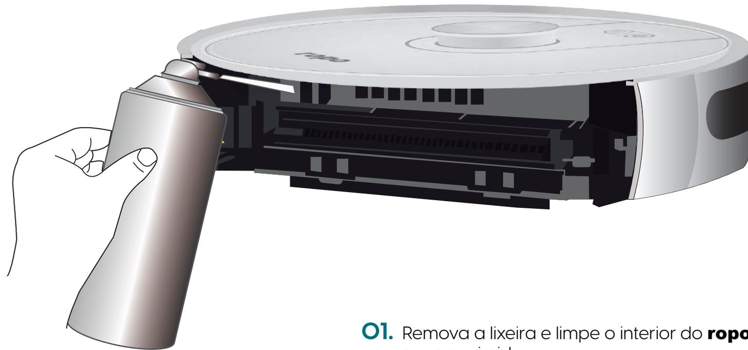
**01.** Remova a lixeira e limpe o interior do **robo** com ar comprimido.
