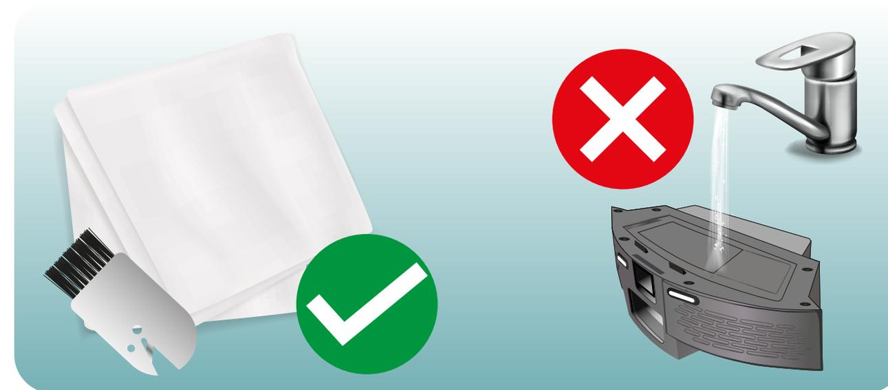
**ATENÇÃO:** A lixeira do **rope Glass 4 Pro** não é lavável. O contato da lixeira com água irá danificar os seus motores, afetando o funcionamento do produto permanentemente. A tampa frontal da lixeira é destacável e pode ser lavada, tomando cuidado com a membrana plástica interna que é fixada na tampa. Certifique-se de que a tampa frontal está seca, antes de fixá-la à lixeira.
