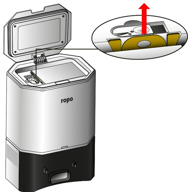
**02.** Após retirar a sacola coletora, é possível limpar o interior da estação de recarga autolimpante usando um pano seco ou a escova de limpeza. A estação possui um filtro na sua turbina que pode ser retirado puxando-o para cima, assim facilitando a sua limpeza. Escove o filtro gentilmente usando a escova de limpeza ou lave-o com água se achar necessário. Quando o filtro estiver totalmente seco, coloque-o novamente no local, atentando-se à sua posição.
