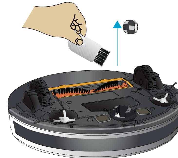
**02.** Com o auxílio da escova de limpeza, retire a sujeira acumulada na roda frontal e no seu suporte. Após a limpeza, encaixe a roda frontal, alinhando o eixo da roda com os encaixes no suporte e pressione a roda até ouvir um som de "click", indicando que a roda foi bem encaixada.
