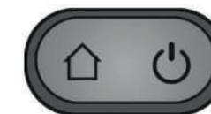
Quando pressionado, o botão **HOME** tem função de enviar o **robo** para a estação de recarga ou para o ponto inicial. Ao pressionar o botão, o robô interromperá o ciclo de limpeza. Em seguida, ele iniciará a busca pela estação de recarga autolimpante, caso ele esteja equipado com a lixeira com turbina, ou retornará ao ponto inicial, caso esteja equipado com o reservatório Wet Clean<sup>PRO</sup>.
