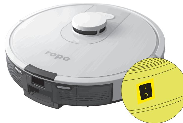
**03** Ligue o interruptor lateral do seu robo, onde "I" significa ligado e "O" desligado.
