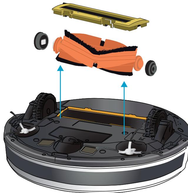
**ATENÇÃO:** Você pode usar uma tesoura para cortar emaranhados de pelos e cabelos, ou pinças para remover resíduos maiores de dentro do robo. A escova central é lavável, porém deve ser lavada sem as roldanas laterais e reinstalada no **robo** somente quando estiver totalmente seca.
