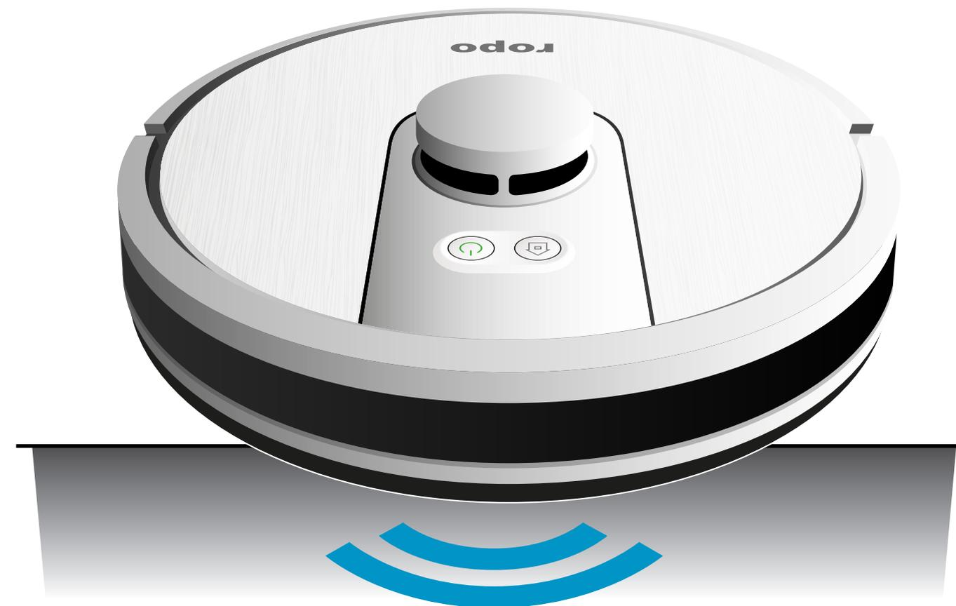
**ATENÇÃO:** Os sensores antiqueda ópticos do **ropo** estão localizados sob o para-choque frontal. Não direcione o robô em ré para degraus ou beiradas pois ele cairá.
