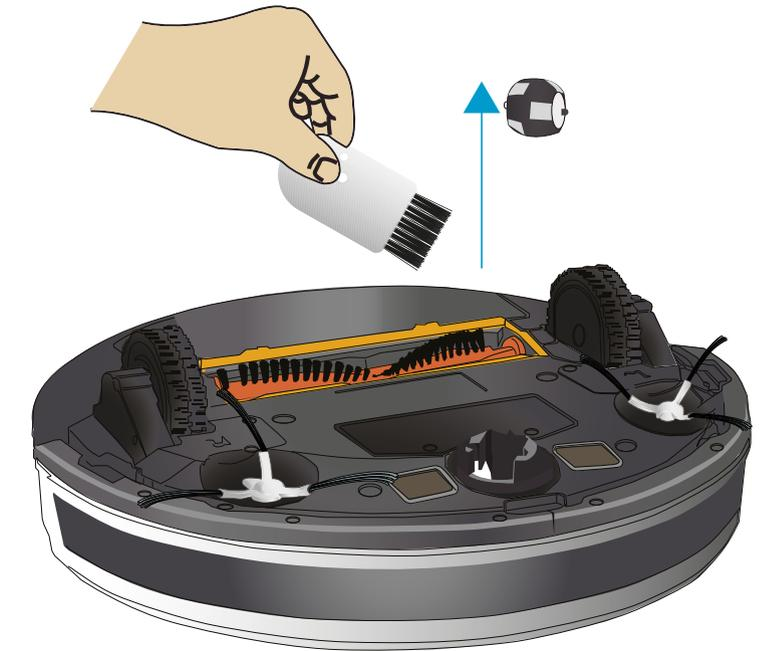
**02.** Com o auxílio da escova de limpeza, retire a sujeira acumulada na roda frontal e no seu suporte. Após a limpeza, encaixe a roda frontal, alinhando o eixo da roda com os encaixes no suporte e pressione a roda até ouvir um som de "click", indicando que a roda foi bem encaixada.
