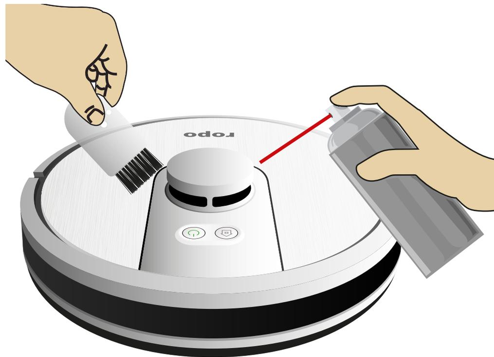
Utilize a escova de limpeza que acompanha o **robo**, um pano macio e seco ou ar comprimido para limpar a torre laser e suas frestas. Não utilize água ou outros líquidos para evitar danos aos mecanismos internos da torre laser.
