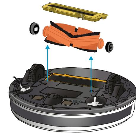
04. Por fim, recoloca a escova central, atentando-se aos encaixes laterais e posição das roldanas. Em seguida, fixe o raspador e verifique se ele está travado no encaixe.
