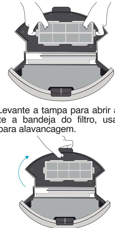
02. Levante a tampa para abrir a lixeira. Levante a bandeja do filtro, usando as guias para alavancagem.
