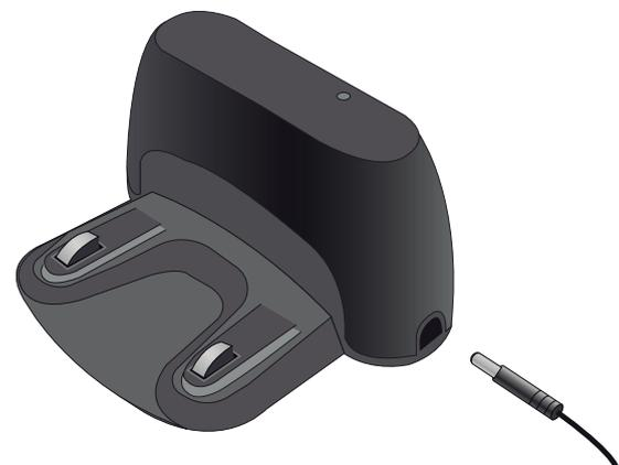
**01.** Conecte o adaptador de energia ao lado da estação de recarga. A luz de energia verde da estação acenderá.
