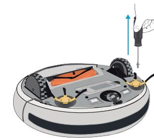
01. Remova os parafusos das escovas laterais e retire-as do robô.
