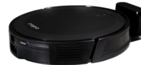
**4.** Posicione o **ropo** na estação de recarga, com os contatos metálicos do chassi do robô encostados nos contatos da estação de recarga. Certifique-se de que o ropo está carregando verificando se a luz do botão HOME está pulsando em branco ou rosa e deixe que o ropo carregue durante 6 horas ininterruptas.
