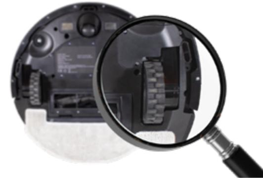
**1.** Desligue o robo. Em seguida, verifique se existe algum objeto preso à roda e remova-o.
