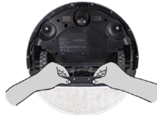
**2.** Encaixe a escova central de volta no robo, se atentando ao posicionamento correto da mesma. Em seguida, encaixe o raspador, empurrando até ouvir o "click" das travas, indicando que o mesmo está preso ao chassi do **robo**.
