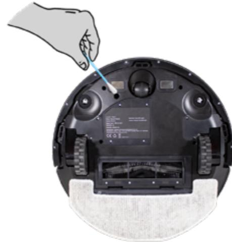
**2.** Para o sensor ultrassônico, limpe-o usando um cotonete e verifique se existe algum objeto preso a ele.
