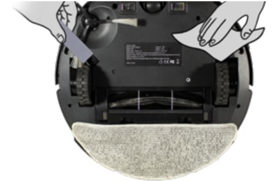
**2.** Limpe as rodas para livrá-las de quaisquer pelos que possam estar impedindo o seu funcionamento.
