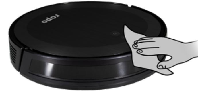
**3.** Para os sensores do para-choque, limpe-os usando um pano seco e macio.
