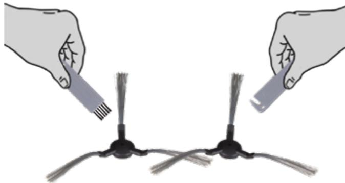
2. Use a lâmina da escova de limpeza para cortar pelos e cabelos enroscados na escova lateral e use as cerdas para limpar o eixo das escovas laterais no **rope**.
