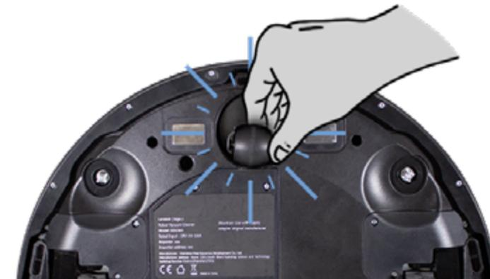
**4.** Coloque a roda frontal de volta no suporte e pressione-a para baixo até ouvir o som de clique, indicando que o eixo foi encaixado no suporte. Após isso, confirme se a roda frontal está bem encaixada e girando.
