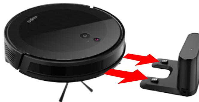
**03.** Coloque o **ropo** em sua estação de recarga com as placas de metal em sua parte de baixo, posicionadas sobre os contatos da estação. A luz do botão HOME irá piscar lentamente em rosa.
