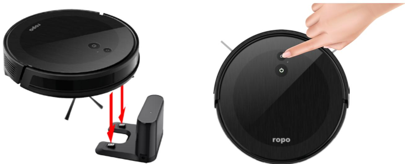
Posicionando o **robo** manualmente na estação de recarga
