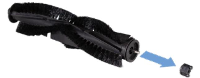
4. A escova central possui uma roldana que deve ser limpa com frequência. Retire a roldana da escova central puxando-a para fora e limpe o seu eixo. Após isso, certifique-se de instalar a roldana de volta na escova central. O uso da escova central sem a roldana acarretará em defeitos ao **robo**.
