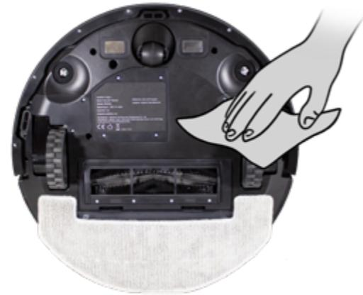
**1.** Para os sensores antiqueda, limpe os sensores usando um pano seco e macio e verifique se existe algum objeto preso aos sensores.
