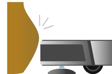
**01.** A fita magnética ropo possui 2 metros de comprimento, mas é possível cortá-la caso seja necessário, respeitando a medida mínima de 30 centímetros. Utilize-a sempre em contato com o solo e sempre se certifique de que a mesma está com boa aderência ao piso, garantindo que ela não se moverá. O intuito é não permitir que o robô desrespeite a demarcação feita.
