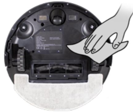
**1.** Retire a sujeira acumulada dos sensores antiqueda e dos contatos de recarga do chassi.
