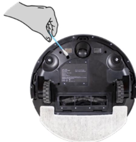
**2.** Com o auxílio de um cotonete, remova a sujeira do sensor ultrassônico.
