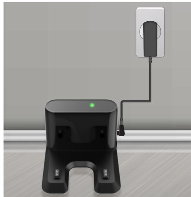
**02.** Instale a estação de recarga contra uma parede, em superfície plana e sólida. Não instale a estação de recarga em superfícies macias, como tapetes ou carpetes. Não posicione a estação próxima a vãos de porta ou passagens, pois o sinal emitido pela estação pode impedir que o **robo** atravesse esses vãos.
