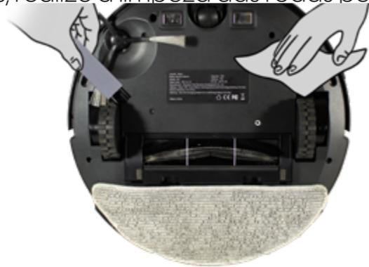
**1.** Limpe as rodas usando a escova de limpeza ou um pano levemente umedecido. Também verifique se existe algum objeto nos vãos entre as rodas laterais e o chassi do **ropo**.
