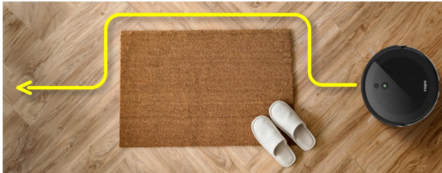
Quando o suporte para pano mop não está acoplado, o sensor ultrassônico fará com que o **robo Smart Pet** ative a aspiração em potência máxima ao detectar um tapete ou carpete durante a limpeza.
