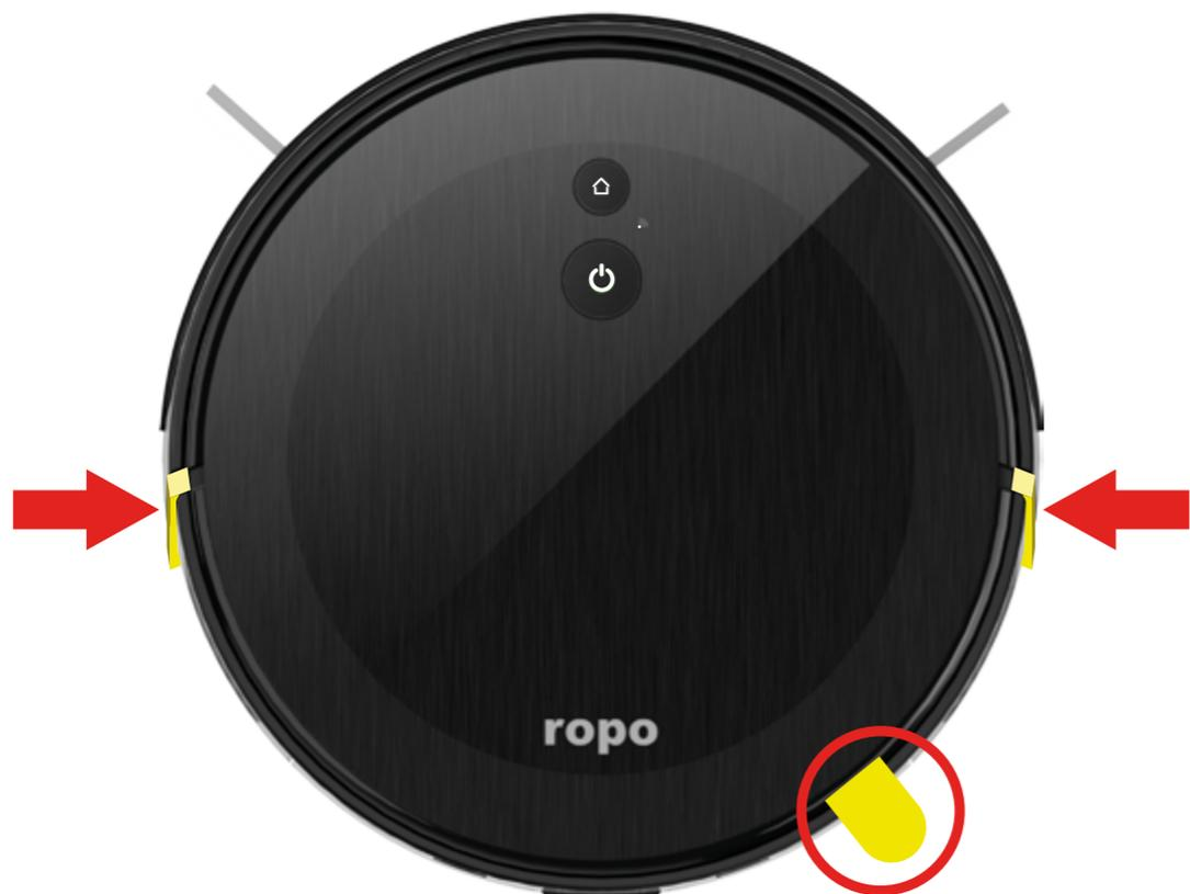
**01.** Remova as proteções emborrachadas das laterais do para-choque para que ele possa retrair corretamente. Caso deseje, remova a película protetora puxando a aba plástica.
