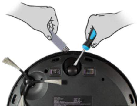
**2.** Utilize uma chave de fenda no vão da roda frontal e faça o movimento de alavanca para suspendê-la, conforme figura acima. Em seguida, limpe o suporte usando a escova de limpeza.
