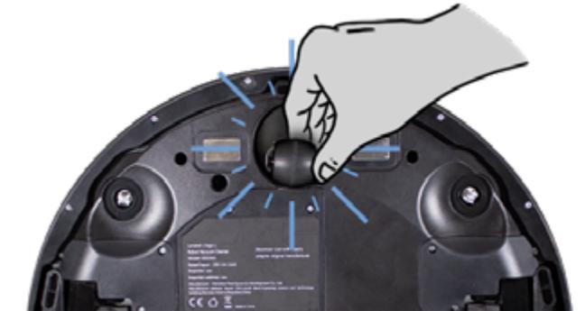
**4.** Ao instalar a roda frontal, pressione-a para baixo no suporte até ouvir os "clicks". Certifique-se de que a roda frontal está bem encaixada e girando livremente em seu eixo.
