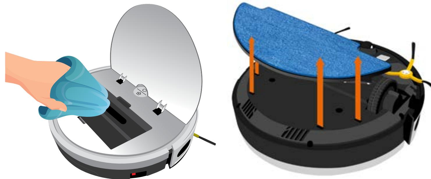
**03-** Remova seu reservatório seguindo a orientação da página 34, após a remoção não esqueça de secar qualquer água remanescente no interior do seu **robo** Way.
