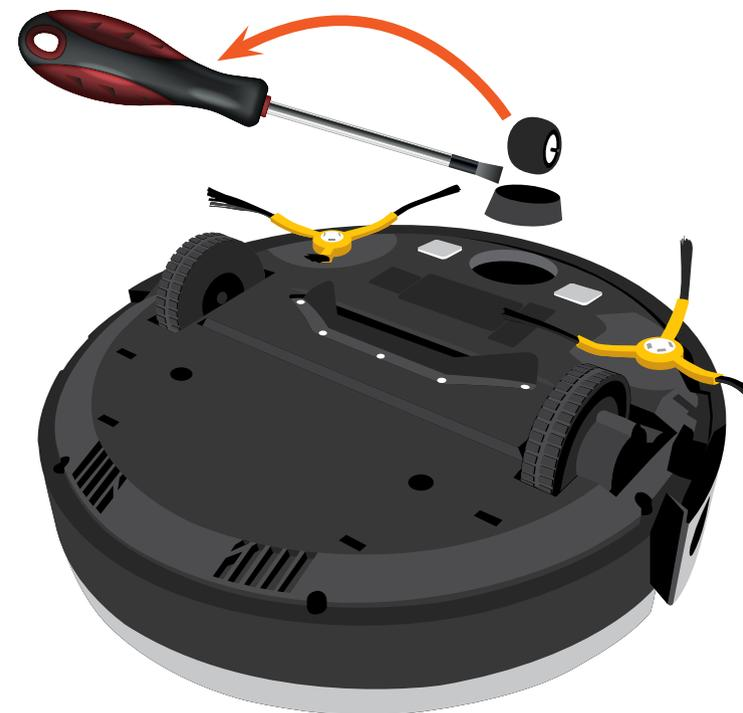
Segure nas laterais da roda com os dedos e puxe na direção oposta ao robô, caso necessário use uma chave de fenda com o movimento de alavanca para remover a roda com a moldura plástica e o pivô. Ao remover a roda você terá acesso a parte de trás, observe a presença de pelos e cabelos no eixo ou no encaixe da roda frontal. Recomenda-se também a limpeza de todo o interior com uma flanela seca.
