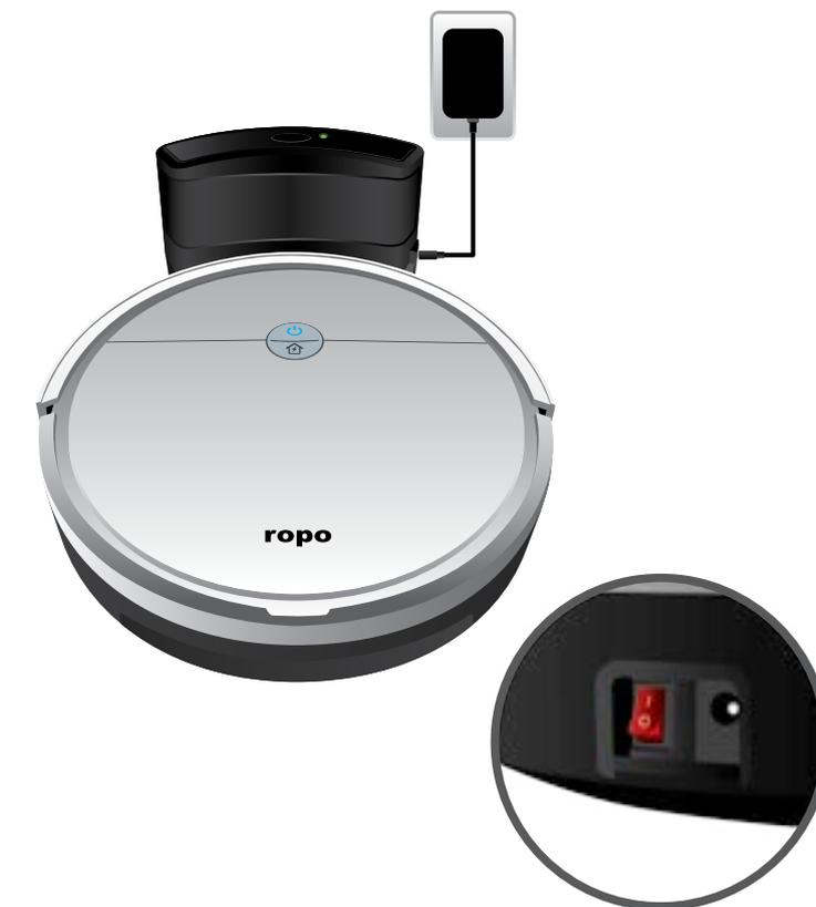
**04-** Após o carregamento por completo, o indicador luminoso do seu **ropo Way** se acenderá em azul. Após isto, ligue a chave lateral do seu **ropo Way** e ele estará pronto para uso.
